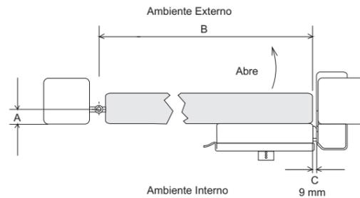
**Importante:** A fechadura deve ser corretamente fixada, de forma a ficar firmemente posicionada e alinhada em relação ao bocal e à folha da porta/portão, deve ter uma estrutura resistente e indeformável, bem como dobradiças que o mantenham sempre alinhado verticalmente.
