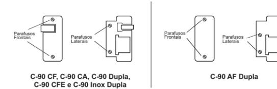
**Colocação da fechadura:** Coloca-se a fechadura na porta de modo que o pino guia fique centralizado em relação ao rolete existente no bocal. A distância do corpo da fechadura até a borda do bocal deve ser de 7mm máximo e de 5mm mínimo para os modelos C-90 Dupla, C-90 CF, C-90 CFE, C-90 CAE, C-90 CA, C-90 Inox Dupla e 9 mm máximo e de 7mm mínimo para a C-90 AF Dupla.
