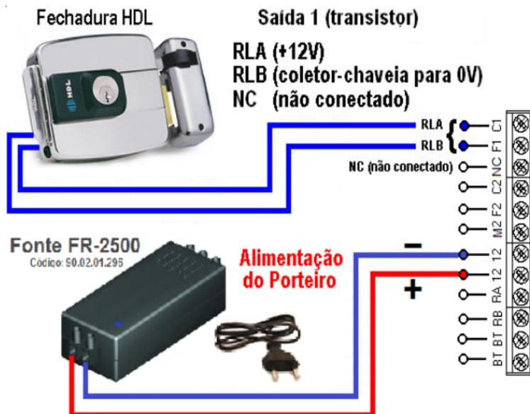
Para este procedimento, necessita programar a fechadura no modo pulsado ou pulso único, conforme apresentado a seguir:
