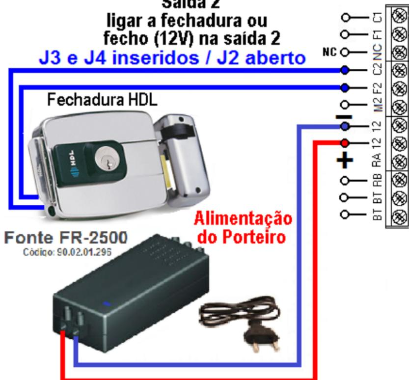
Para este procedimento, necessita programar a fechadura no modo pulsado ou pulso único, conforme apresentado a seguir:
