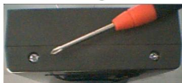
Abrir a Unidade Externa de Porteiro Eletrônico F12 SVCAx para acesso à parte interna onde se encontram: ajuste do volume do alto-falante, jumpers de configuração, bornes de ligações, alto-falante e câmera.
